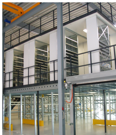
P90 palletstellingen met daarboven een ME250 vloer waar weer HI280 legbordstellingen op zijn geplaatst. Bovenop de legbordstellingen een vrije vloer met balustrade.
